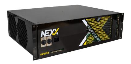
先駆けて発売されたNEXX-5RU同様、NEXX-3RUは柔軟性とさらなる進化を提供します。3RUはフライトパックや中継車などの狭いスペースにフィットするよう、5RUの約半分の高さと奥行きで設計されています。クロスポイントとモジュールは全て背面フレームからアクセス可能で、フレーム内に冷却ファンと電源を内蔵した3RUサイズです。他の機器を直接NEXXの上下に重ねることが可能です。
